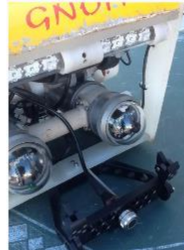
Подводный телеуправляемый аппарат (ТПА) Супер Гном ПРО с установленным ультразвуковым толщиномером Cygnus
